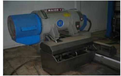
Décanner à trois phases
